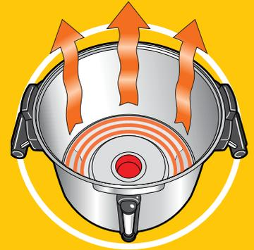
Sistema de calentador doble central hace el café, y después se apaga. El calentador moderado exterior mantiene el café a una temperatura constante de servir sin recalentarlo.
